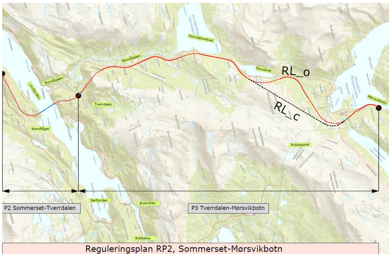
Figur 2: På strekningen Sommerset – Mørsvikbotn varsles det planoppstart for 2 ulike E6-traseer med tanke på å involvere entreprenørkompetanse underveis i reguleringsplanleggingen
