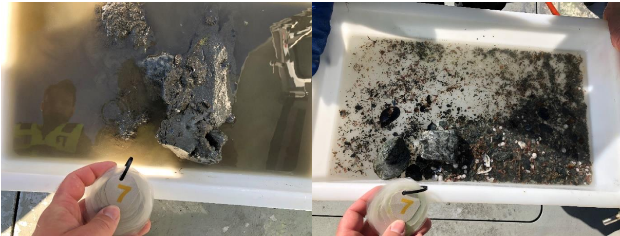
Figur 12: Bilder som viser sedimentet fra stasjon 7 før og etter siling. Sedimentet besto av leire, silt, grus og stein. Foto: Aqua Kompetanse AS.
