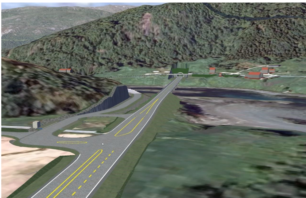
Figur 38: Utsnitt 3D modell, løsning for ensidig bussholdeplass på Evjen sør for Megården
