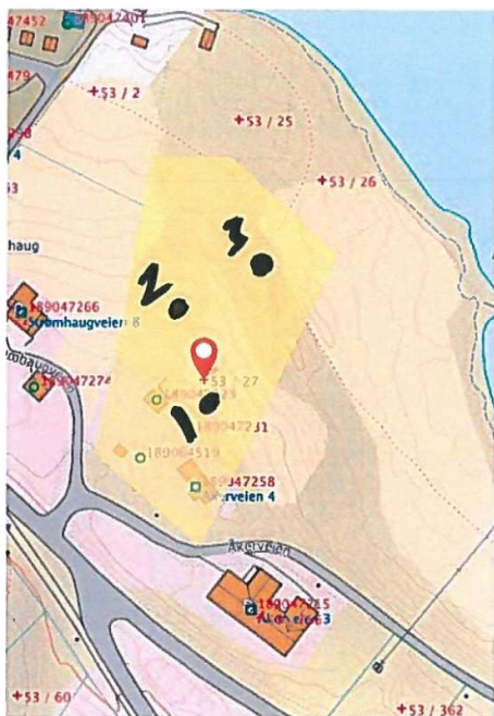
Figur 26. Kartutsnittet angir punktene 1, 2 og 3 hvor det er foretatt grunnundersøkelse ved graving ned til 3 m dybde.
